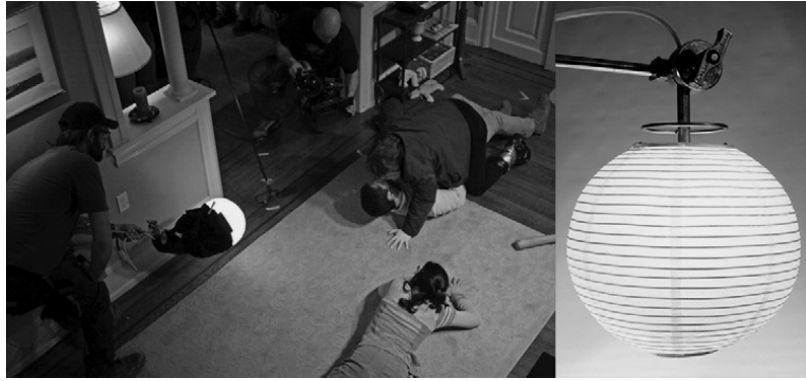
Hình 06.15: Gaffer tay giữ đèn lồng giấy để chiếu sáng mặt diễn viên trong trình tự quay. Lanternlock làm ra đèn lồng giấy kết hợp khung/ổ cắm an toàn gắn vào đèn lồng giấy tiêu chuẩn để có thể đặt ở bất kỳ vị trí và chân C nào. Lồng đèn giấy có nhiều kích cỡ (12, 24 và 30 inch), cũng có loại hộp hình chữ nhật. Treo đèn lên chân C, với bóng đèn photoflood trong ổ cắm sứ (không dùng ổ cắm nhựa 60-W, đôi khi bán chung với đèn lồng, bóng photoflood sẽ đốt cháy nó).
