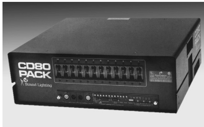
Hình 06.10: Dimmer pack Strand CD80. Dimmer pack 12 channel hiển thị ở đây có 12 mạch dimmer, mỗi cái được bảo vệ bởi một CB 20-A. Trung tâm của dimmer pack (card điều khiển) được gắn vào mặt trước (dưới CB), trong đó có cable điều khiển inputs/outputs, bộ chỉ thị, và switches để setup.
