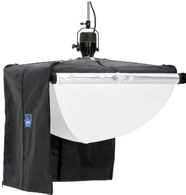
Hình 06.16: Thiết bị đèn lồng, 35 inch. thực hiện bởi Chimera, cho ra ánh sáng mềm rực rỡ, có trọng lượng nhẹ và dễ treo trong khu vực diễn xuất. Váy đen giúp điều chỉnh ánh sáng, và giữ ánh sáng không rọi lên tường. Lồng đèn như trên làm bằng vật liệu gỗ ghè, không cháy. Hãng sản xuất cung cấp thiết bị có nhiều kích cỡ, với chân cắm trung bình (lên đến 500W) và chân cắm mogul (lên đến 1000W). cũng có phiên bản HMI.
